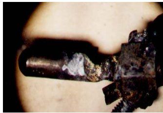
그림 40. 플러그단자에 형성된 트래킹에 의한 변형형태
