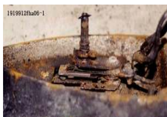
그림 72. 다리미에 장착된 바이메탈 방식의 온도조절기
