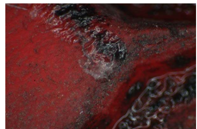
그림 8. 방화 용의자 신발 바닥에 부착된 현장 용융물
