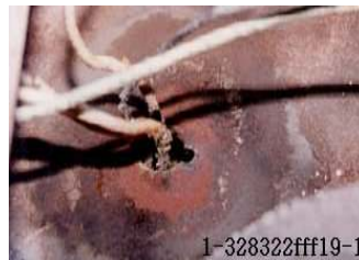
그림 51. 전원코드(석면코드)와 철재몸체 간의 단락흔
