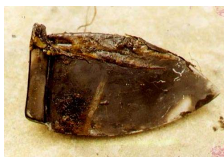
그림 70. 발열 중인 다리미에 가연물이 접촉되어 발화된 형태
