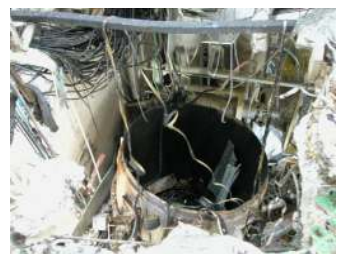
그림 41. 폭발된 반응조 상태
