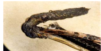
그림 32. 동파방지용 히터와 전원코드를 꼬아 연결시킨 상태
