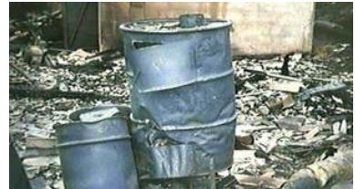
그림 17. 사용 중이 아니었던 화목난로의 연소 후 형태
