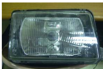
그림 29. 전조등 렌즈 좌우측, 상하단 등의 부분에 부착차종, 위치 등이 각인되어 있음(예 : 현대 소나타 시리즈)
