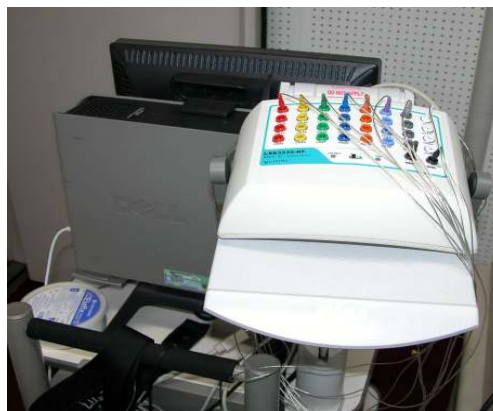
그림 2. ERP 측정용 EEG장비
