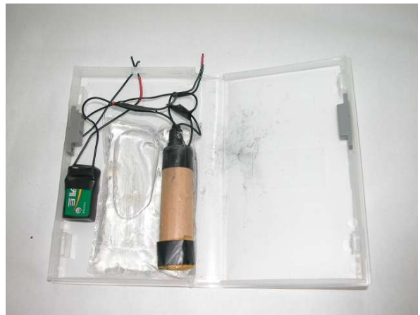
그림 116. 마그네틱 스위치를 장착하여 비디오테이프 케이스를 열면 터지도록 고안된 사제폭발물
