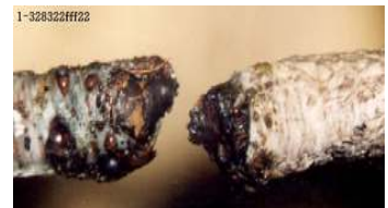
그림 52. 히터의 석면전원코드가 금속몸체와 접촉 절연이 파괴되어 단락이 발생하여 주변의 먼지 등 가연물에 착화
