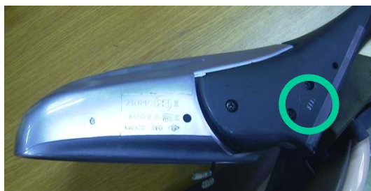
그림 31. 차량 후사경 제조회사 및 생산년월
